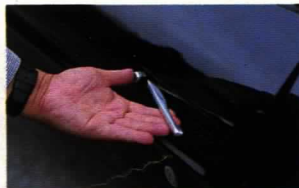
▲レトロ感覚演出の最たるものが、その昔、ザガート系のボディによく使われた、このドア・アウトワードハンドルだ。
