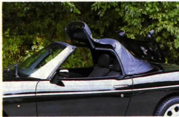
▲ソフトトップは、ご覧のように折れ込む。作業自体は、それほど力を入れる必要もなく、ひとりでも簡単にできる。残る問題は耐久性だが、造りはガッチリとしたものだ。
